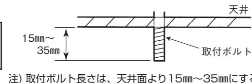
(注) 取付ボルト長さは、天井面より15mm~35mmにする。
